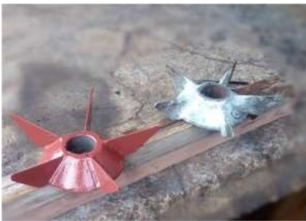
Ремонт крильчаток електродвигуна К 90/85 агр. № 10 НСП Лощинівської ЗС
