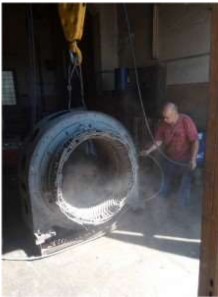
Ремонт крильчаток електродвигуна К 90/85 агр. № 10 НСП Лощинівської ЗС
